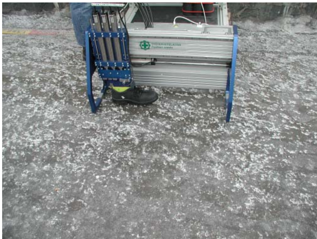
Kuva 5. Mitattaessa jäästä ( T = -6^{\circ}\text{C} ), jolla oli ohut kerros vastasatanutta lunta, saatiin kitka-arvoksi 0,12 liukkaalle ja 0,15 pitävälle jalkineelle.
