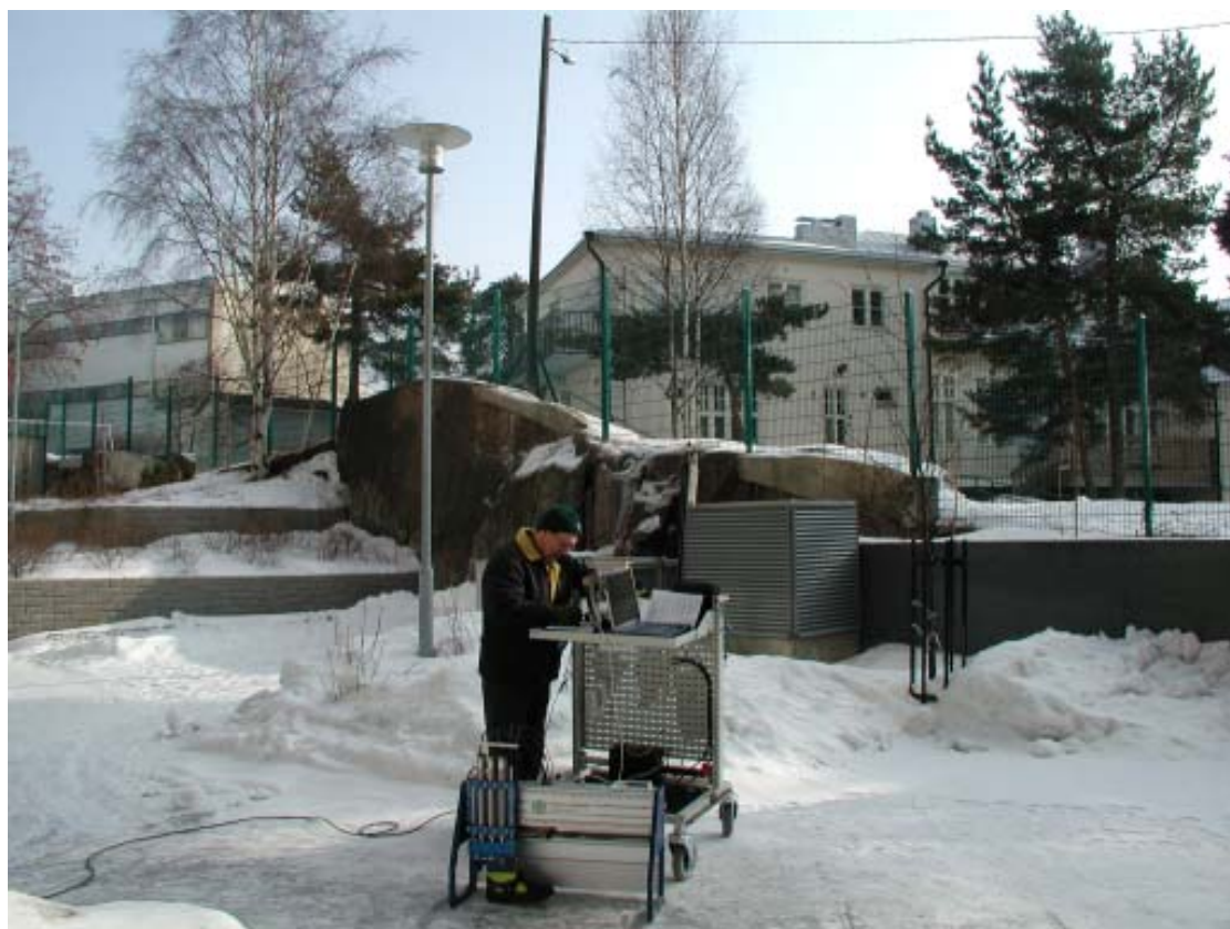
Kuva 1. Siirreltävä liukkausmittari Työterveyslaitoksen pihalla sijaitsevassa mittauspisteessä.
