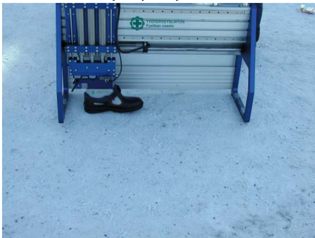
Kuva 6. Normaalina talvipäivänä muutaman asteen pakkasessa saatiin tulokseksi 0,18 liukkaalle ja 0,50 pitävälle jalkineelle, kun alustana oli kevyesti hiekoitettu, tallaantunut lumi.
