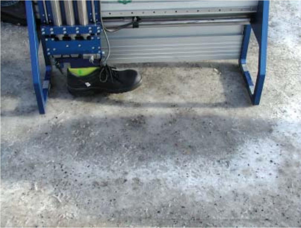
Kuva 7. Hiekoittamattomalla vetisellä jäällä mitattiin kitka-arvoiksi 0,12 ja 0,18 liukkaalle ja pitävälle jalkineelle. Mitatut kitkakertoimet kaksinkertaistuivat, kun mitattiin vastaavasta pisteestä, jossa oli hiekoitusta.
