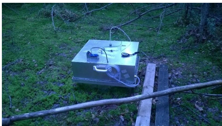
Kuva 3. Manuaalinen maakammio metsäkortekorvessa (MkK). Kammion päällä on letkulla varustettu tulppa, jonka kautta näytteenotto tapahtui. Tulppaan oli kiinnitetty myös lämpöanturi, jonka kautta kammion sisäistä lämpötilaa voitiin mitata.
