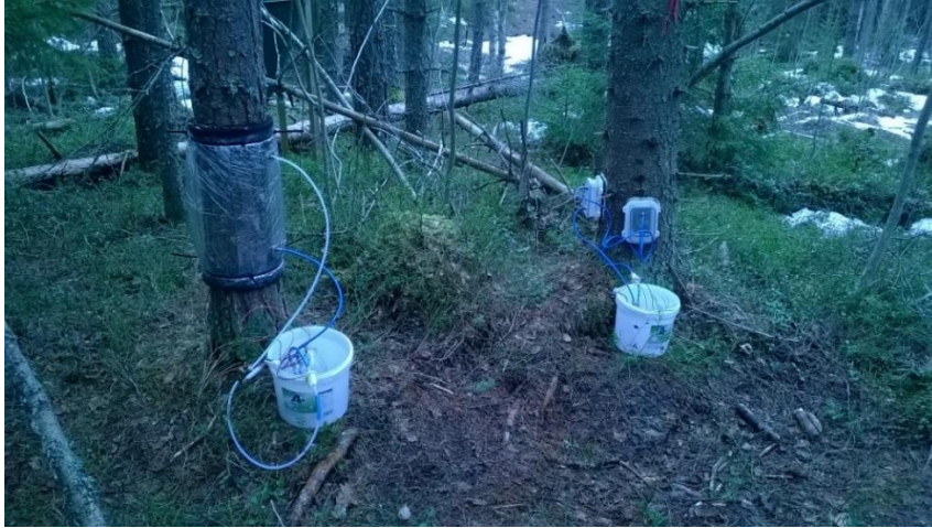
Kuva 4. Koepuiden runkoihin asennettiin kahdenlaisia runkokammioita. Kuvassa oikealla oleva rasia-mainen kammioityyppi oli käytössä kuivahkolla kankaalla, ja soistuneella koealalla käytettiin vasemmanpuoleisen tyyppisiä, lieriömäisiä kammioita. Kuvassa olevat koepuut eivät liity tähän työhön.
