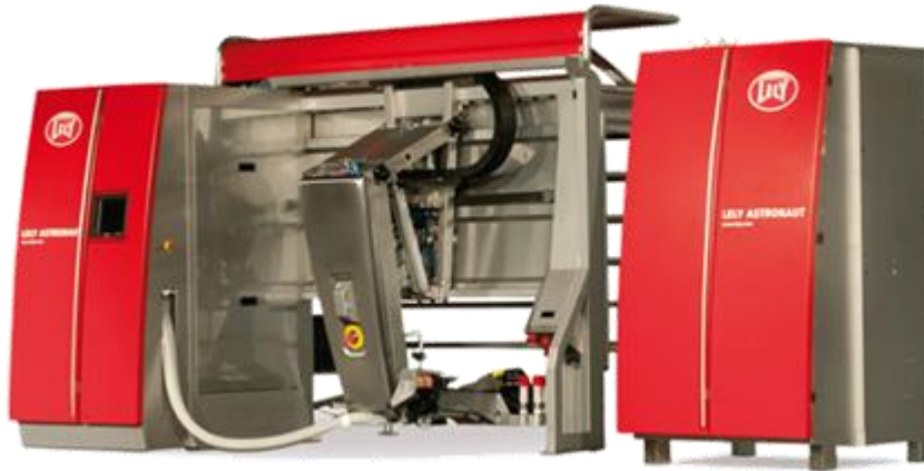
Kuva 4. Lelyn uusiin lypsyrobotteihin Astronaut A4 tuli markkinoille vuonna 2011. Edellisistä malleista poiketen A4 koostuu kahdesta moduulista, robotista ja keskusyksiköstä. Kuvan julkaisemiseen saatu lupa Jussi Savanderilta
