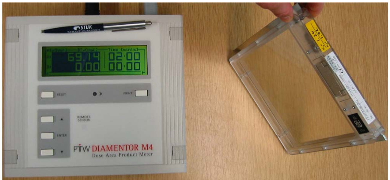
Kuva 5. DAP -mittari (PTW Diamentor). Vasemmalla on mittarin näyttöosa ja kynä osoittamassa kuvan mittakaavaa. Oikealla on DAP -kammio
