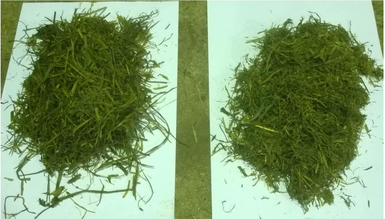
Kuva 2. Käsittelemätöntä nurmisäilörehua (vas.) ja tilamittakaavan kaksoisruuvipuristimella fraktioitua säilörehun kiintojaetta (oik.) kokeesta I. Kiintojakeessa on nähtävissä fraktioinnin aiheuttama kasvin rakenteen rikkoutuminen (Kuva Luke/Marketta Rinne).
