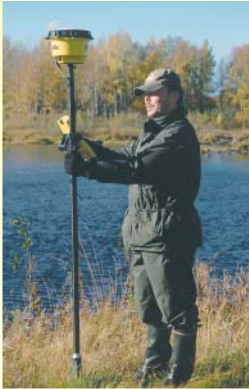
Suojavyöhykelohkon mittausta GPS-laitteella.
