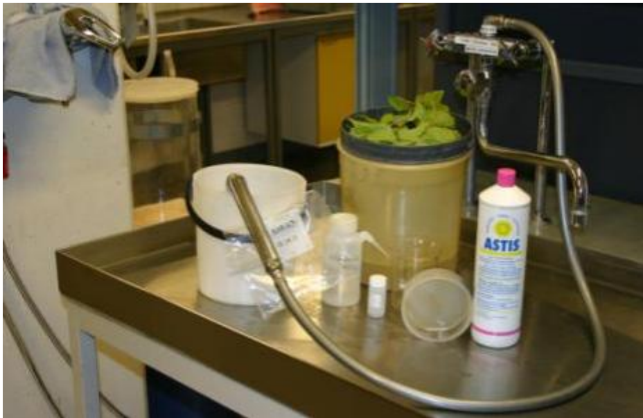
Kuva 1. Lehtien pesussa käytetyt tarvikkeet. Kuvassa vasemmalta oikealle pesuämpäri, näytepussi, nokkapullo, näytepullo, siivilä \varnothing 1,5 mm ja \varnothing 0,0015 mm.
