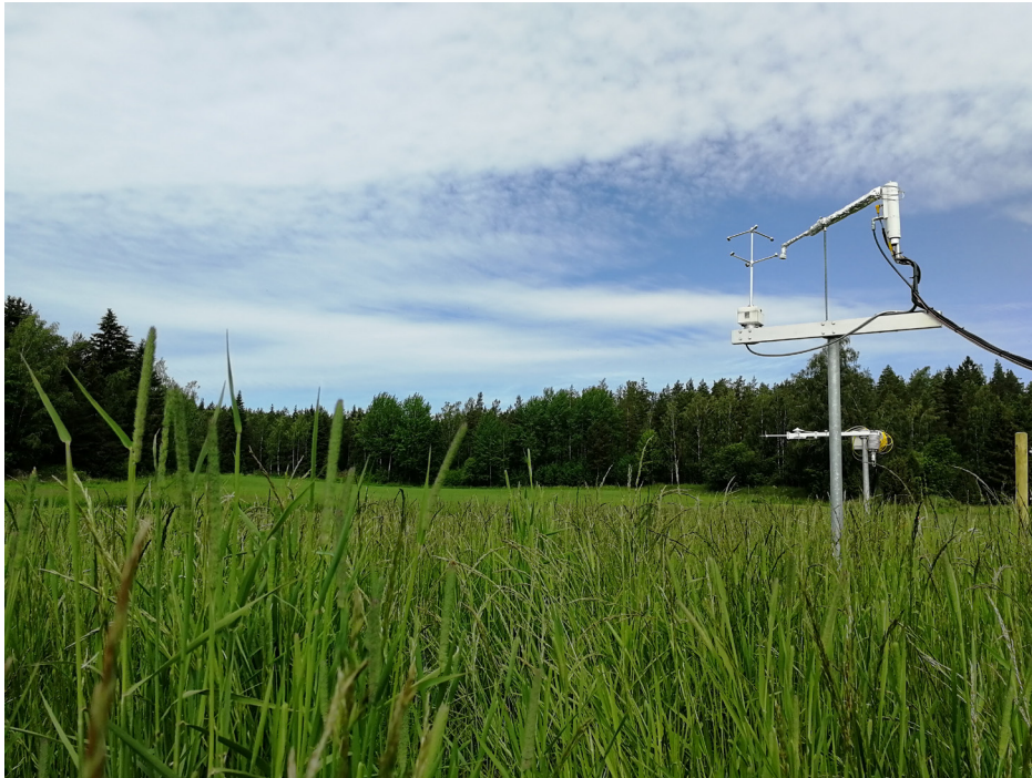
Kuva 16. Pyörrekovarianssilaitteisto Qvidjan nurmella. Kuva: Laura Heimsch
