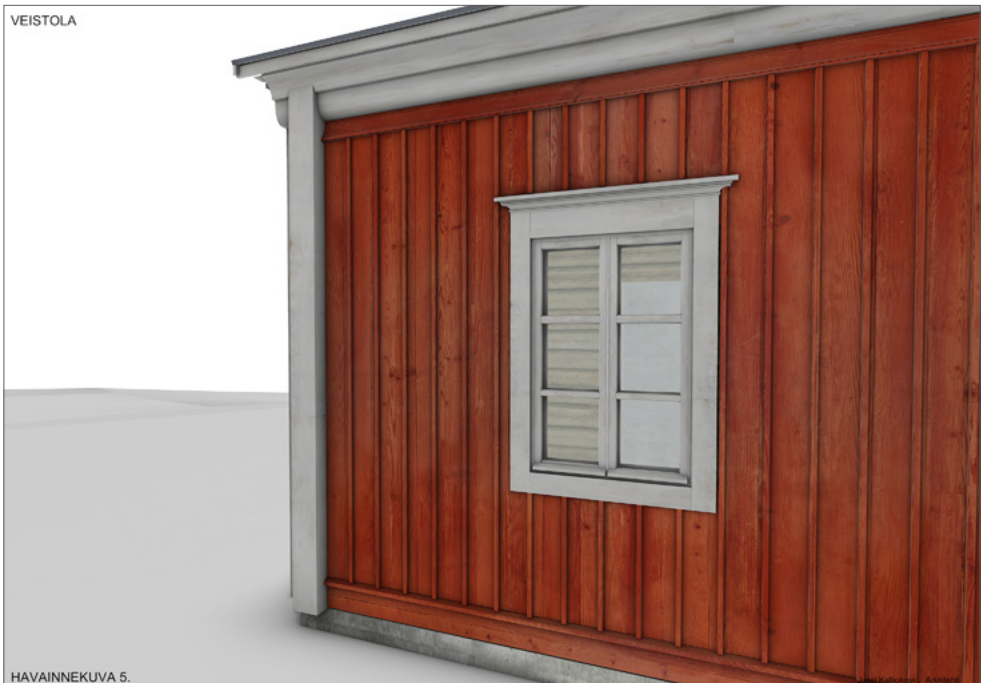
HAVAINNEKUVA ULKO- JA IKKUNAVUORAUSSLAUDOITUKSEN TOTEUTUKSESTA. KUVA JUSSI KALLIOKOSKI.
