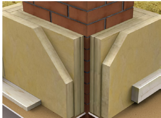
HAVAINNEKUVA PIIPUN NYKYMÄÄRÄYKSET TÄYTTÄVÄSTÄ LÄPIVIENNISTÄ VÄLIPOHJASSA. KUVA MATTI PALOSAARI.
