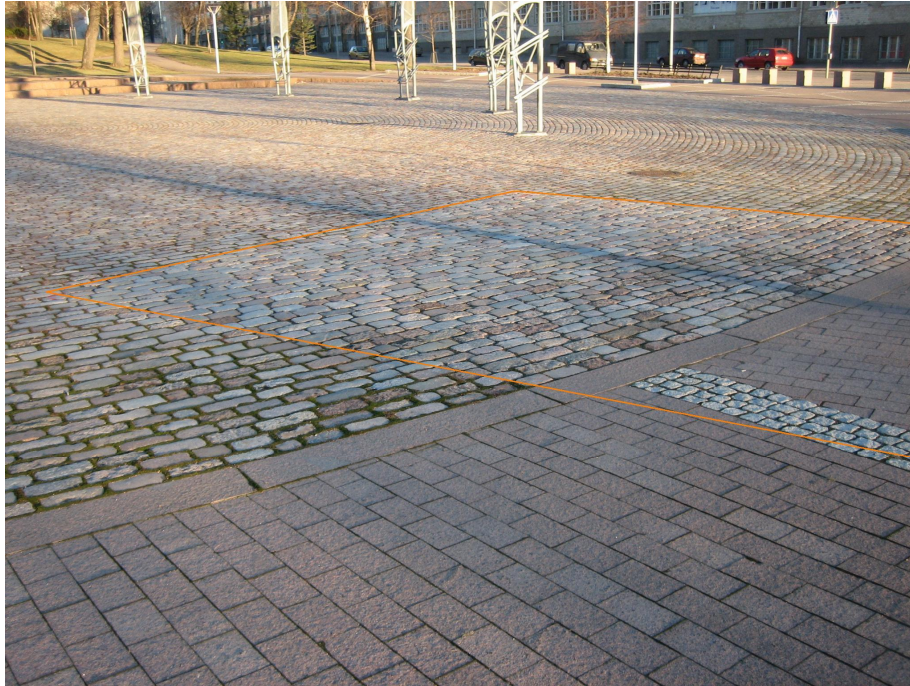
Kuva 9. Arabian koepaikalla etikkahapolla käsitelty koealue erottuu selkeästi ympäristöstä noin neljä kuukautta kokeen päättymisen jälkeen.
