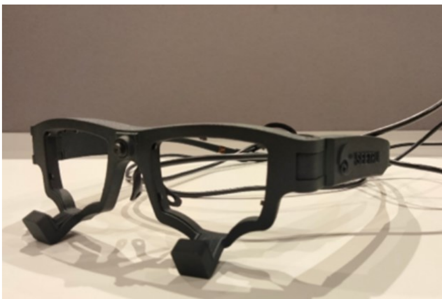
Kuvio 3. Tutkimuksessa käytetyt SeeTrue Technologiesin katseenseurantalasit (Tomi Kiviluoma, 2024).
