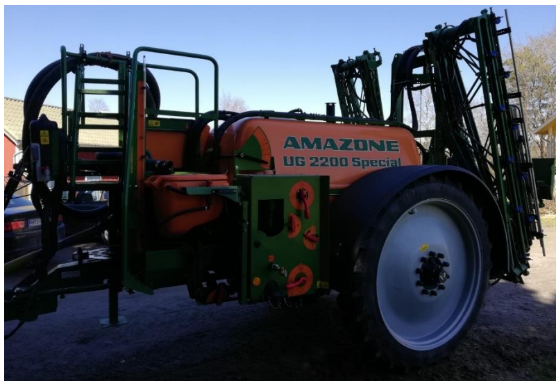
Kuva 9. Kasvinsuojeluruisku (Amazone UG 2200 Special, työleveys 18m), jolla ruiskutettiin lohko 2:n rikkakasvintorjunta-aineet ja tuhoeläintorjunta-aineet. (Kuva: Maria Pero, kuvan käyttämiseen on saatu kuvaajan lupa.)
