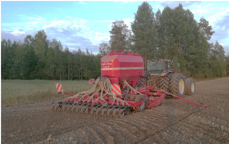
Kuva 6. Herneen kylvössä käytetty pneumaattinen kylvölannoitin (Horsch, jonka työleveys oli 3 m ja riviväli 12,5 cm). (Kuva: Maria Pero, kuvan käyttämiseen on saatu kuvaajan lupa.)
