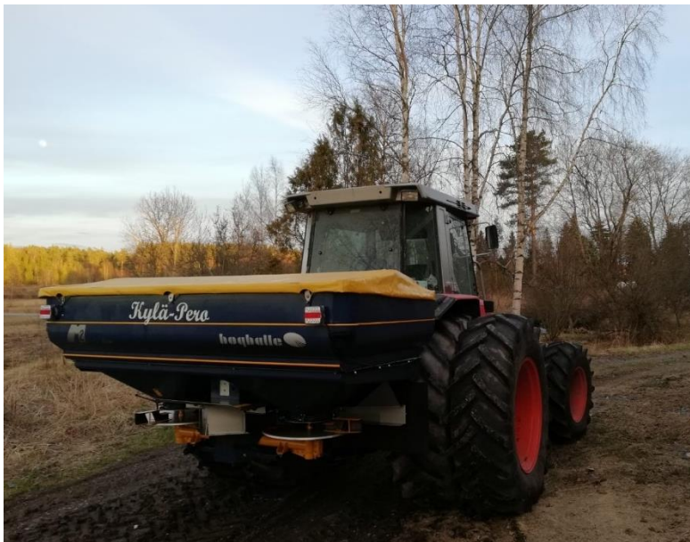
Kuva 7. Kalkkityypen (Perlka®) levitykseen käytetty pintalevitin (Bogballe ja työleveys 12–18 m). (Kuva: Maria Pero, kuvan käyttämiseen on saatu kuvaajan lupa.)
