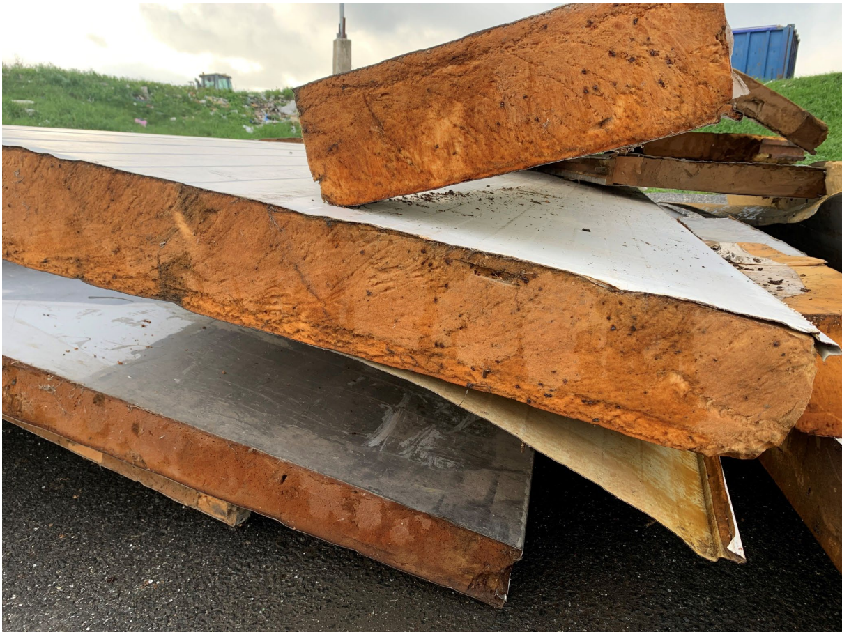
Kuva 64. Purettuja rakennuseristeitä. Kuva: Annika Johansson.
