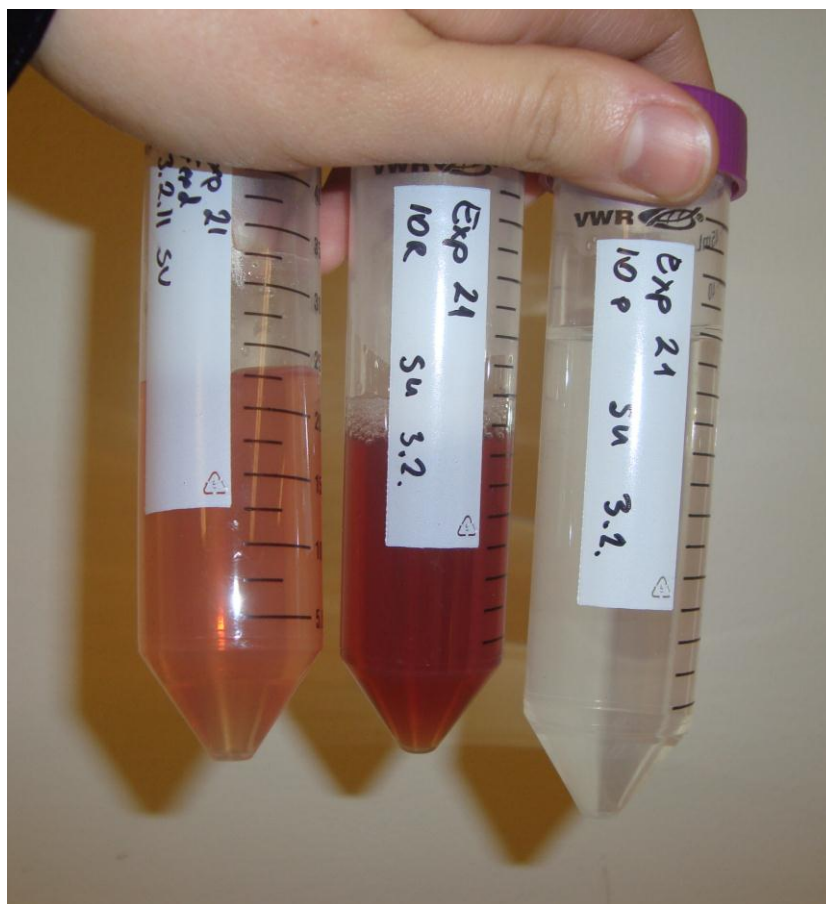
Kuva 6. Vasemmalla plasma ennen ultrasuodatusta, keskellä plasmakonsentraatti eli ultrasuodatuksen retentaatti suodatuksen jälkeen sekä oikealla plasmasta suodatuksella erotettu permeaatti.
