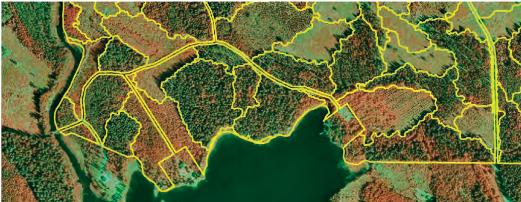
Kuva 14.7. Automaattikuvioinnin (segmentoinnin) tavoitteena on tuottaa mahdollisimman lopullista kuviorajauksa. Kuviointiin upotetaan kiinteistörajat, vedet, pellot, tiet ja linjat. Lopulliset metsikkökuviot yhdistellään pienemmistä mikrokuvioista ja rajauksia viimeistellään tarvittaessa myös manuaalisesti. Kuva SMK/Arbonaut Oy.
