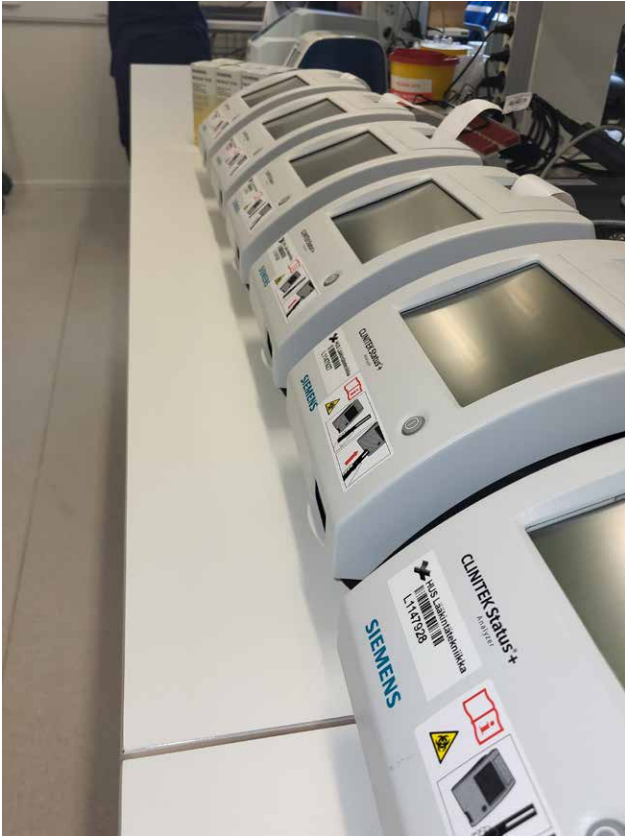
Virtsanliuskanlukuaitteiden verifiointi alkamassa.
