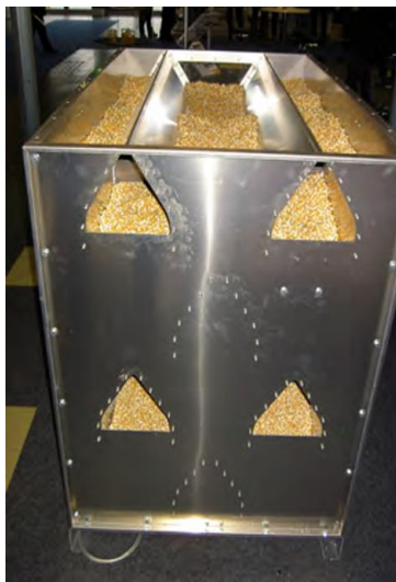
Kuva 6. Harjakennorakenne Kuva: Hautala ym. 2013. Maatilakuivurit. Viitattu 31.3.2025.
