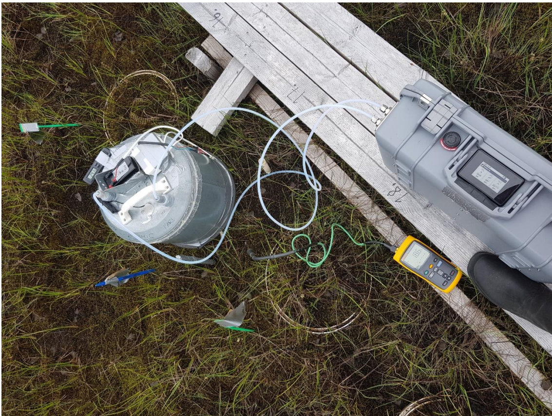
Kuva 6. Mittauskammio ja kaasuanalysointi (Kuva: Elli-Noora Kamppuri).
