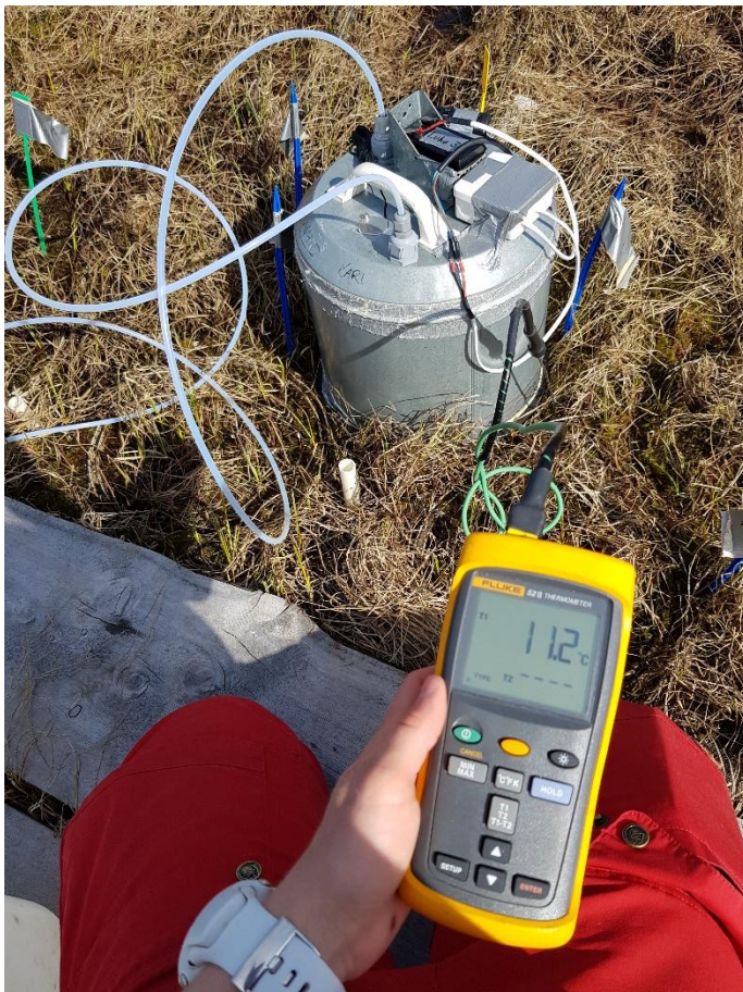
Kuva 14. Lämpömittari ja anturi turpeen lämpötilan mittaamiseen (Kuva: Elli-Noora Kamppuri).
