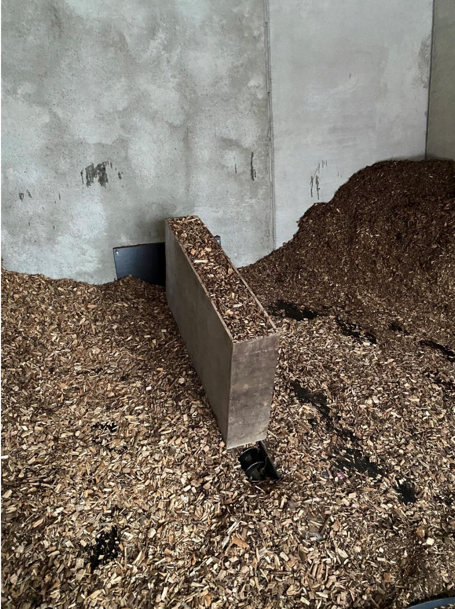
Kuva 9. Vanerilaatikko asennettuna syöttöruuvien päälle koetta varten. (Kuva: Roni Viitala)
