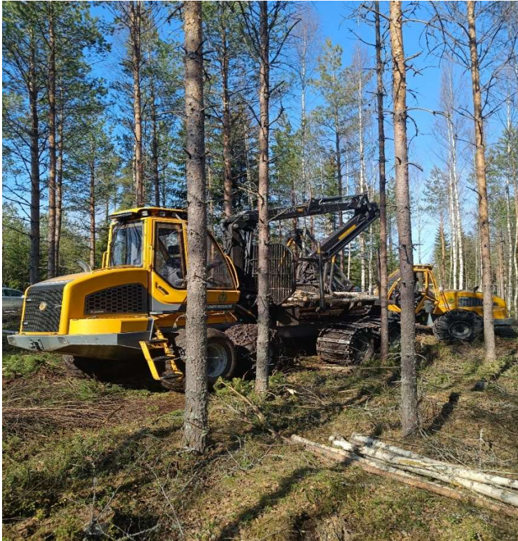
Kuva 2. Metsänhoitoyhdistys Österbottenin sopimusurakoitsijan pienikokoisista koneista koostuva korjuuketju ensiharvennuksella Närpiössä (Kokkonen 2023)
