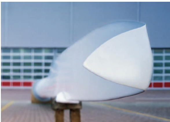
Kuva 8. Siiveke tuuliturbiinin lavan kärjessä. Profili on muotoiltu osana komposiittilapaa. /7/
