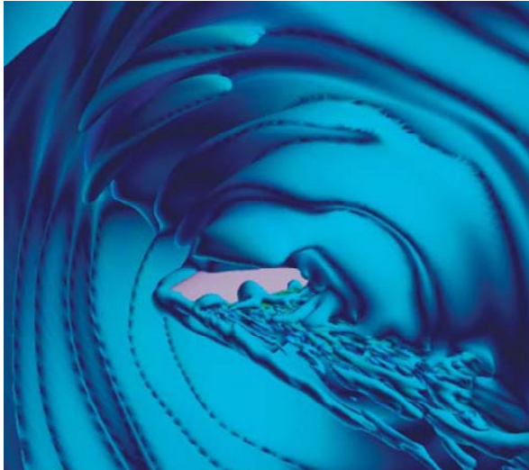
Kuva 7. Tietokoneavusteisella virtauslaskennalla (CFD +LES) voidaan tutkia eri lapaprofilien vaikutuksia ilmassan turbulenssiin ja siten melun määrään siiven yli. /6/
