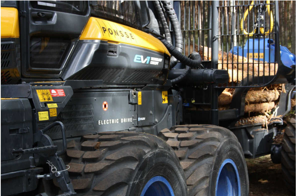
Kuva 9. Ponsse EV1 -tuotekonseptikuormatraktorissa on täysin sähkökäyttöinen voimalinja. Koneen ajovoimansiirto toimii vain akuista saatavalla energialla. Konseptikoneessa akuston lataamiseen käytetään koneen dieselmoottoria (Ponsse Oyj). Kuva: Kalle Kärhä.
