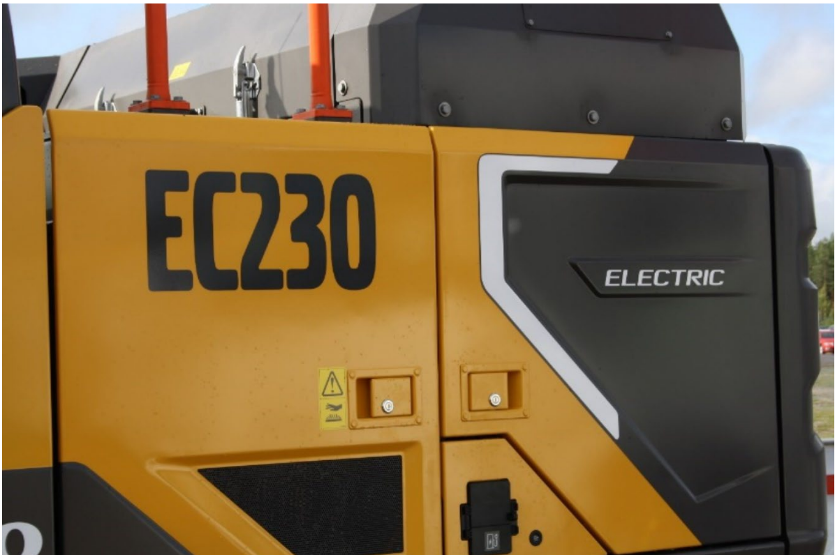
Kuva 7. Volvo EC230 Electric -kaivukoneessa on 600 V:n litiumioniakusto, jonka kapasiteetti on 264 kW. Käytöstä riippuen käyttöaika on 4–5 tuntia. Pikalaturilla (150 kW) lataus kestää noin 1,5 tuntia ja 32 ampeerin (A) pistokkeesta (latausteho 22 kW) noin 10 tuntia (Volvo Construction Equipment Finland Oy). Kuva: Kalle Kärhä.
