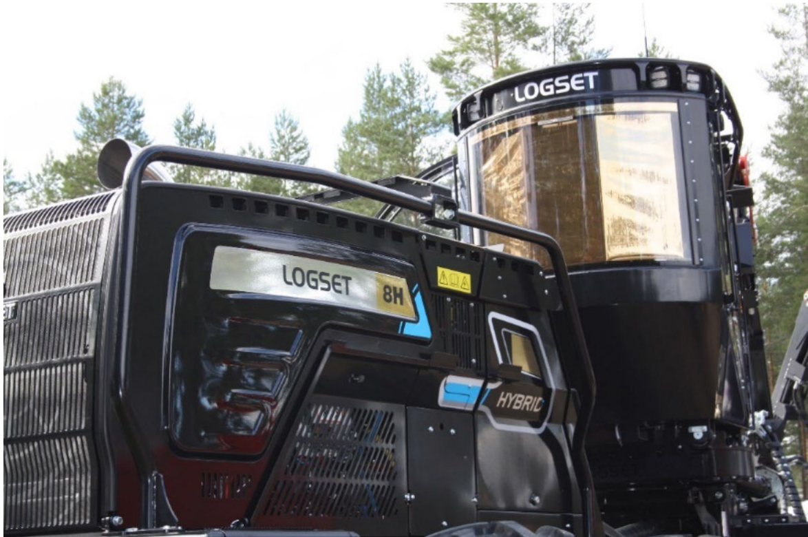
Kuva 6. Logset 8H GTE Hybrid -hakkuukoneessa on 214 kW:n dieselmoottori ja 104 kW:n hybridijärjestelmä tarjoaa lisävoimaa, kun koneella käsitellään isoja puita (Logset Oy).
